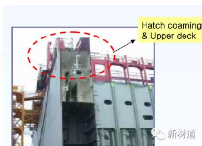
集装箱船航行过程中的受力部位（舱口围）结构
